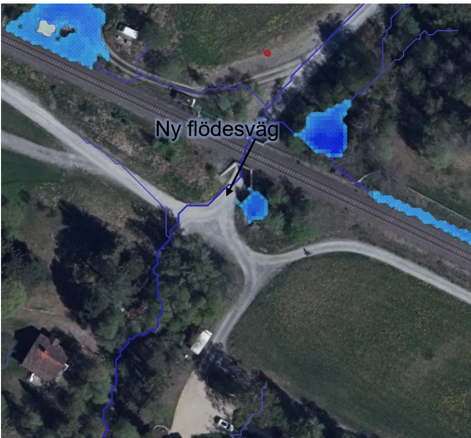
Figur 6-4. Järnvägen, ny flödesväg längs bilväg, flödet återansluter till vattendraget nedströms korsningen.
