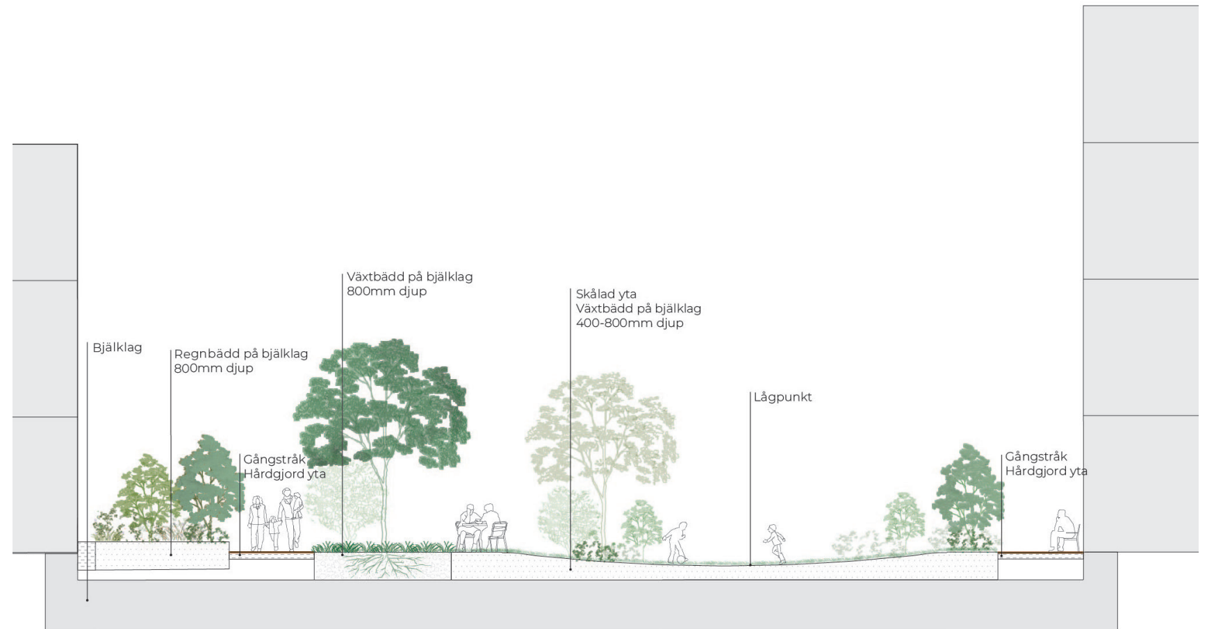
Exempel på uppbyggnad av bjälklagsgård där växtligheten getts goda förutsättningar överleva på lång sikt
