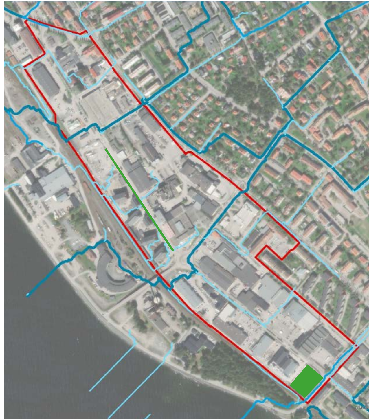
Karta som visar rinnvägar vid skyfall i området idag, markerade med blått. Kartan visar också de två befintliga dagvattenanläggningarna i området, markerade med grönt.
