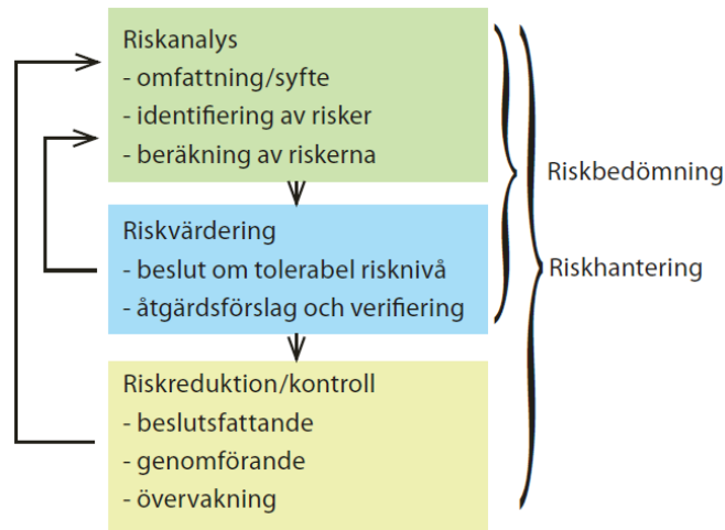
Figur 2. Schematisk bild över processen vid genomförande av riskutredningar. (Länsstyrelserna Skåne län, Stockholms län, Västra Götalands län, 2006).
