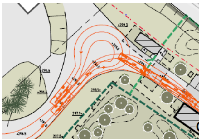
Utsnitt ur förslag till situationsplan som visar hur en vändplats kan anordnas i anslutning till byggnad där avfallshantering kan rymmas (Illustration: Tengbom Arkitekter).
