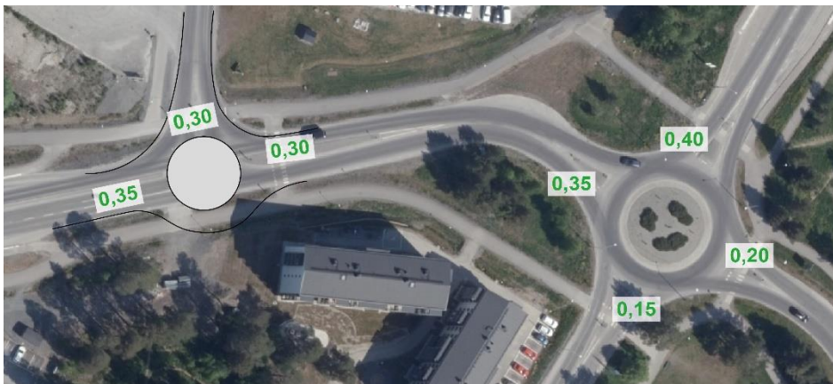
Figur 10. Belastningsgrader i varje tillfart för förmiddagens maxtimme. För korsningen mellan Arenavägen och Pampasvägen visas en cirkulationsplats schematiskt, ytbehov och utformning har inte kontrollerats.
