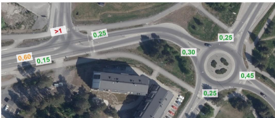
Figur 9. Belastningsgrader i varje tillfart för eftermiddagens maxtimme.
