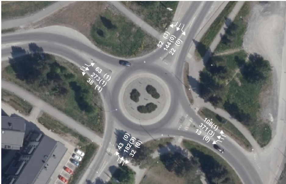
Figur 6. Svängrörelser under eftermiddagens maxtimme i korsningen mellan Arenavägen och Pampasvägen. Uppdelat på personbilar och inom parentes antal tunga fordon.
