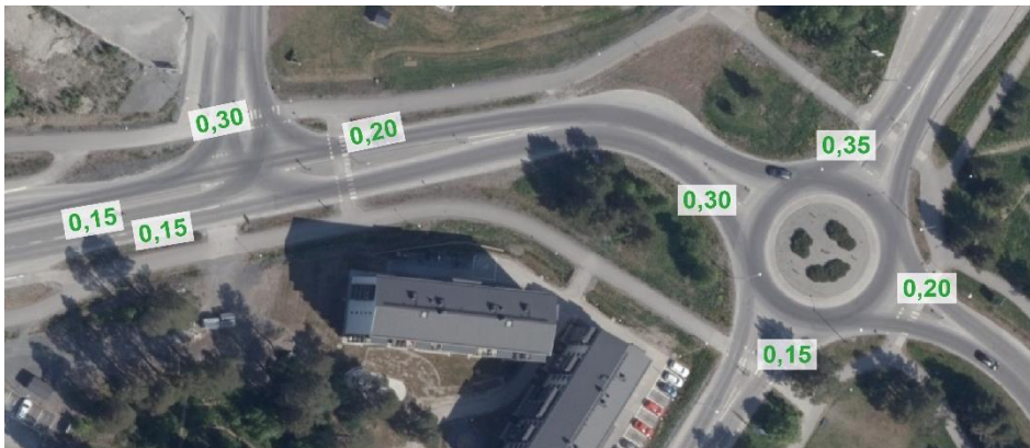
Figur 8. Belastningsgrader i varje tillfart för förmiddagens maxtimme.
