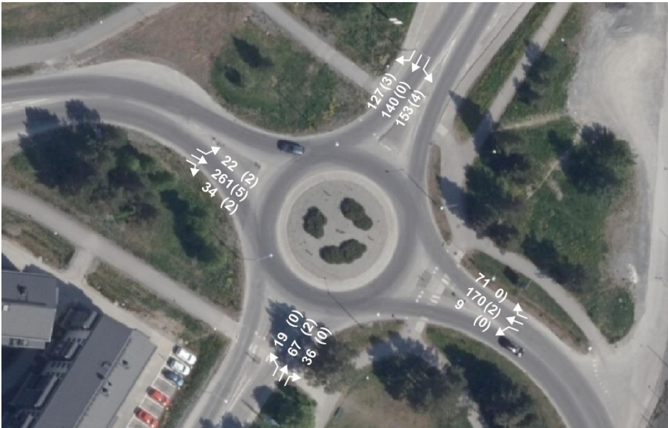
Figur 4. Svängrörelser under förmiddagens maxtimme i korsningen mellan Arenavägen och Pampasvägen. Uppdelat på personbilar och inom parentes antal tunga fordon.
