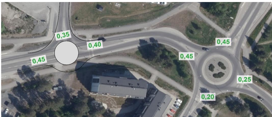
Figur 12. Belastningsgrader i varje tillfart för förmiddagens maxtimme. För korsningen mellan Arenavägen och Pampasvägen visas en cirkulationsplats schematiskt, ytbehov och utformning har inte kontrollerats.
