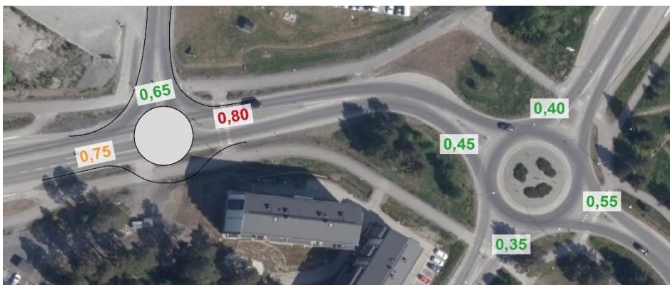
Figur 13. Belastningsgrader i varje tillfart för eftermiddagens maxtimme. För korsningen mellan Arenavägen och Pampasvägen visas en cirkulationsplats schematiskt, ytbehov och utformning har inte kontrollerats.
