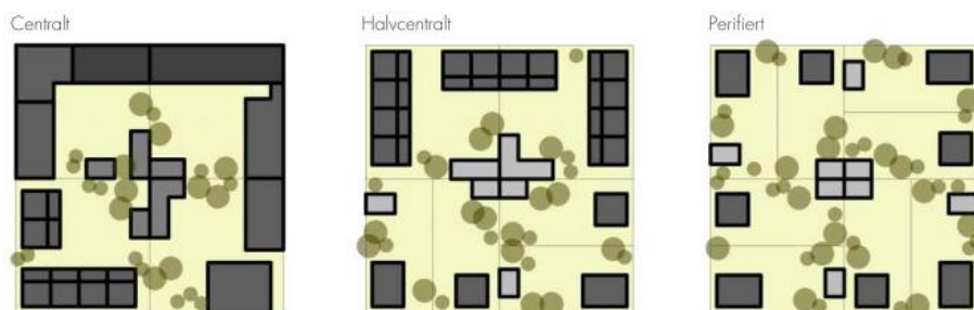
Figur 5: Typkvarter med olika täthet. Typkvarter 1 motsvarar de centrala, mer tätbebyggda områdena närmast väg 592. Typkvarter 2 motsvarar kvarter lokaliserade i halvcentrala lägen, något kvarter från huvudgatan. Typkvarter 3 är lokaliserade mer än två kvarter från huvudgatan (Östersunds kommun, 2016).
