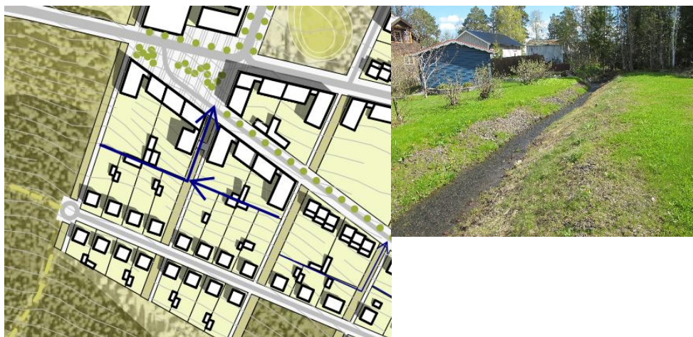
Figur 29: Avledning av dagvatten sker nedströms om tomter vars fastighetsgräns gränsar till en annan fastighet. Till höger i figuren visas ett exempel på ett svackdike med grusad botten mellan två fastigheter.
