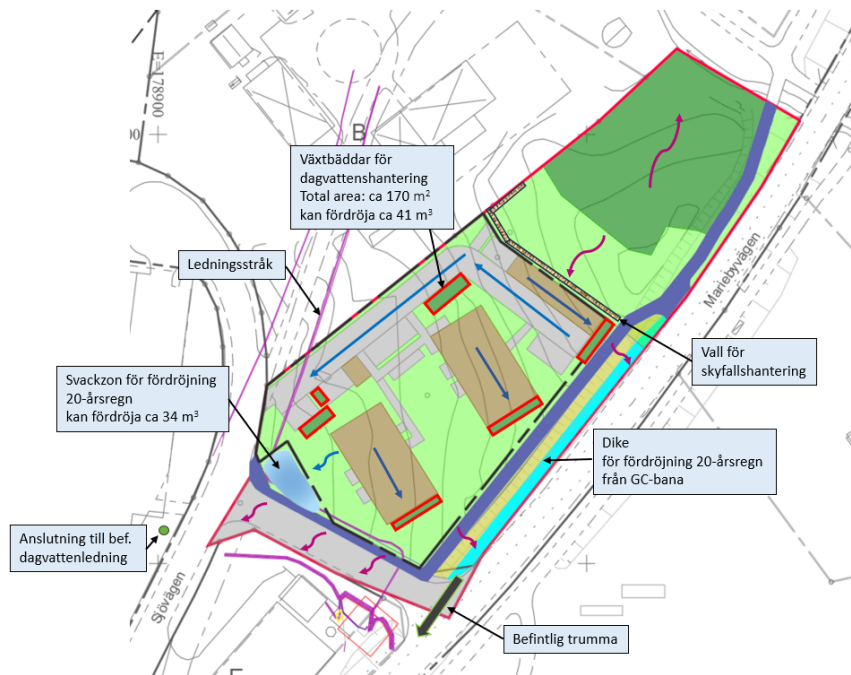
Illustrationen visar förslag på dagvattenlösningar inom planområdet
