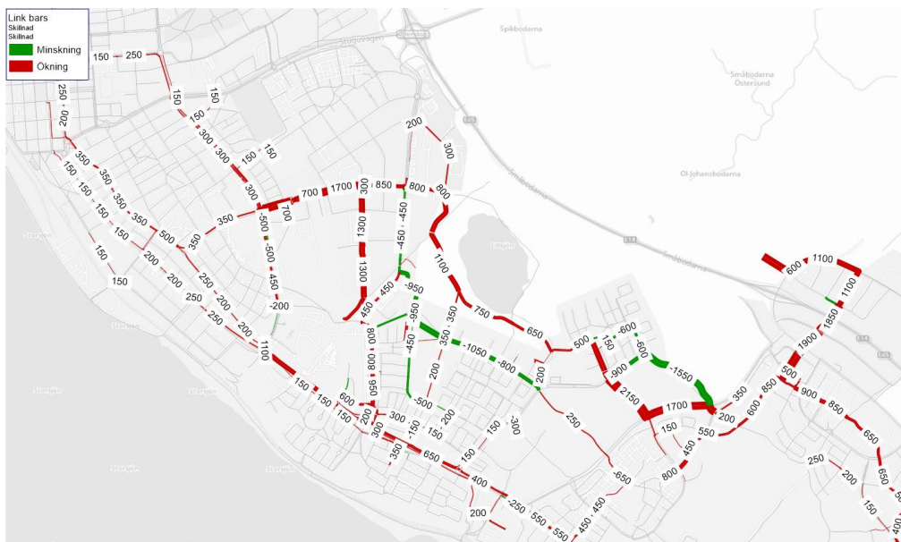
Figur 49. Skillnadsbild mellan UA2050 mot JA2030 för scenario Mål med cykeltrafikflöden. Det vill säga vilka effekter för cykeltrafiken som fullt utbyggt FÖP Södra Östersund för med sig.
