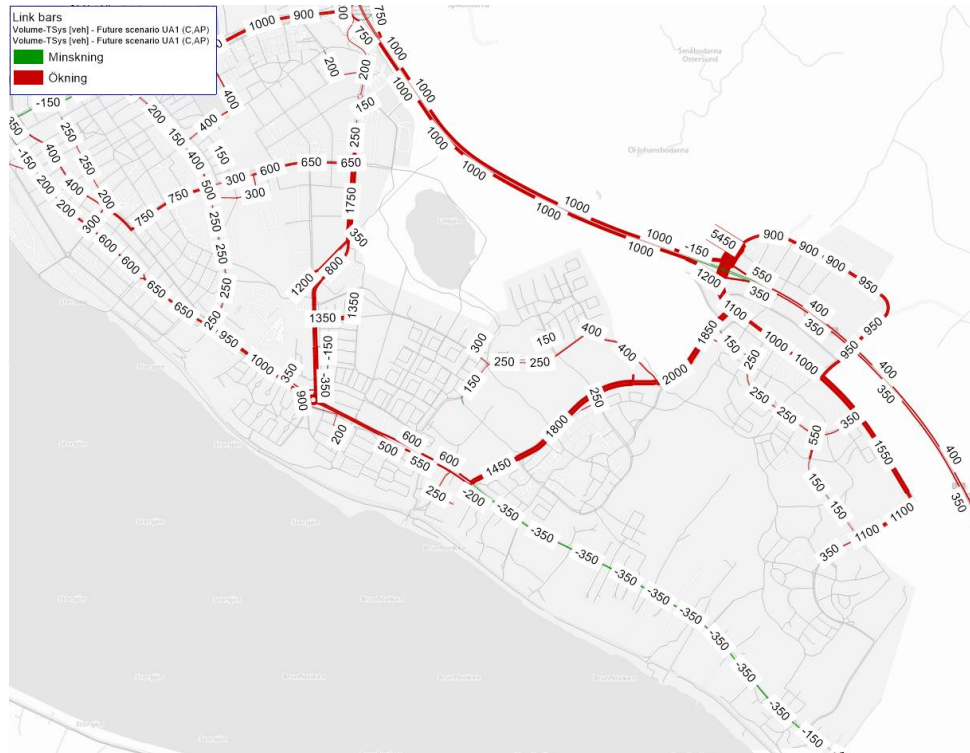
Figur 47. Skillnadsbild mellan UA2050 mot JA2030 för scenario Mål med biltrafikflöden. Det vill säga vilka effekter för biltrafiken som fullt utbyggt FÖP Södra Östersund för med sig.
