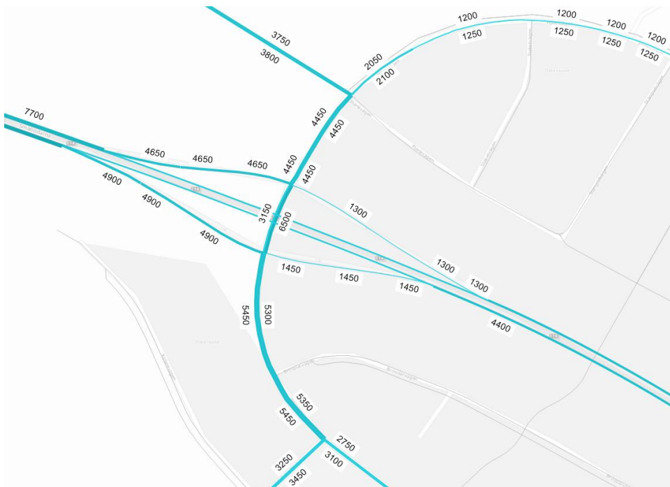
Figur 40. Biltrafikflöden i prognosmodellen för UA2050 Bas runt trafikplats Torvalla för båda riktningarna.
