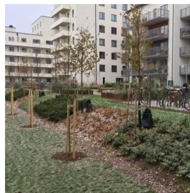
Exempel på plantering på gårdsbjälklag som också fungerar som fördröjningsyta för dagvatten. Till vänster: Brf Klätterträdet, Gillebäcken, Göteborg. Foto: Veidekke. Till höger: Östra Sala backe, Uppsala. Foto: Östersunds kommun
