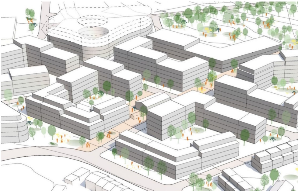
Norra delen med bebyggelse i mestadels slutna kvarter i tre till sex våningar, samt indragen våning i vissa lägen (parkeringshus i fyra till sju våningar)
