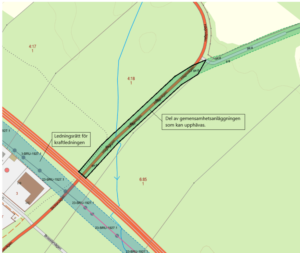
Figur 8: Gemensamhetsanläggningen längs Hägnvägen och ledningsrätten över Skotarvägen.
