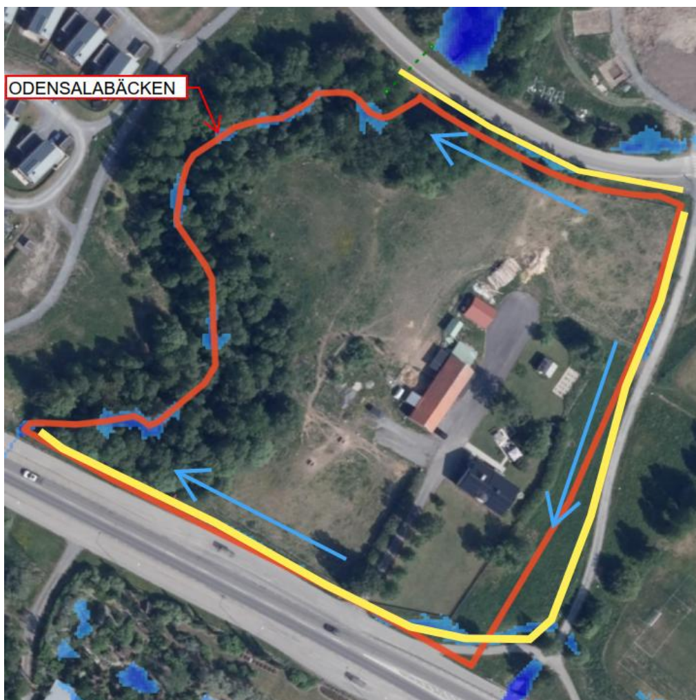
Figur 8. Befintlig dagvattenhantering. Planområdet (rött), Befintliga diken (gult) Blåa pilar flödesriktning. Modifierad bild Scalgo Live, -2026
