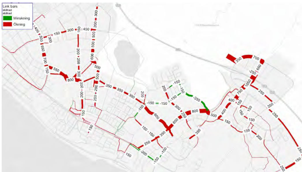
Figur 43. Skillnadsbild mellan UA2050 mot JA2030 för scenario bas med cykeltrafikflöden. Det vill säga vilka effekter för cykeltrafiken som fullt utbyggd FÖP Södra Östersund för med sig.
