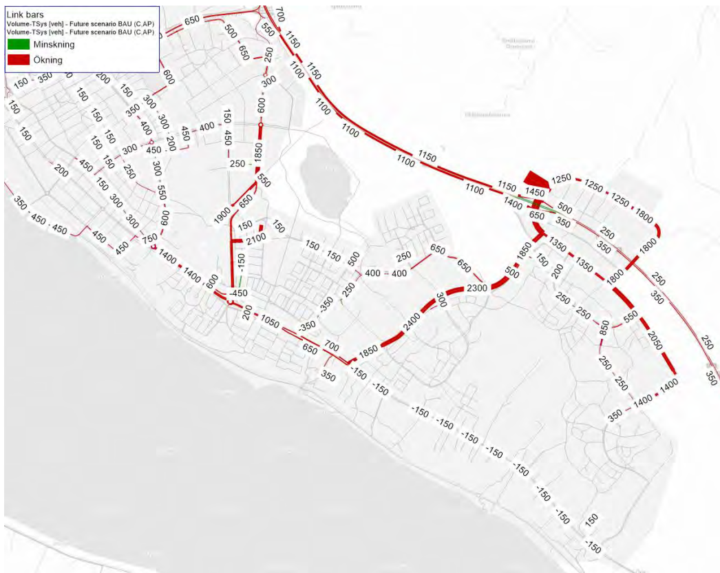
Figur 42. Skillnadsbild mellan UA2050 mot JA2030 för scenario bas med biltrafikflöden. Det vill säga vilka effekter för biltrafiken som fullt utbyggd FÖP Södra Östersund för med sig.
