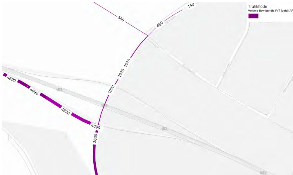
Figur 29. Flowbundle-analys på scenario Bas där den västra avfartsrampen är markerad för att se vart enbart detta biltrafikflöde rör sig. Nära 80 procent i modellen svänger höger mot Basvägen under ett dygn.
