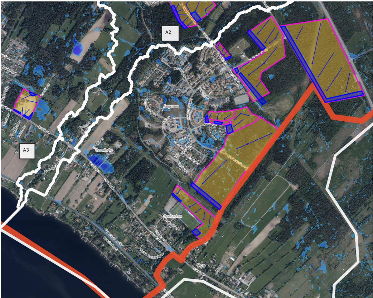
Figur 7.15. Lokalisering av uppsamlande åtgärder i delområde A4. Utvecklingsområden (magenta med gul skraffering), lokalisering av dagvattenåtgärder (blå skraffering), förstärkta avrinningsriktningar (blå pilar), förslag på styrande avledning (gröna pilar), lågpunkter/stående vatten vid skyfall (ljusblå områden), delavrinningsområdesgräns (vit) och planområdesgräns (röd).
