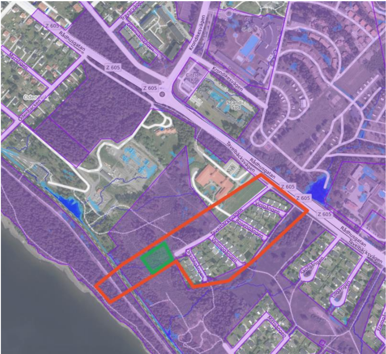
Figur 8.6. Identifierat skogsområde för hantering av dagvatten som tas fram i dagen (grönt), dagvattennätets upptagningsområde (rött), och kommunal mark (lila).
