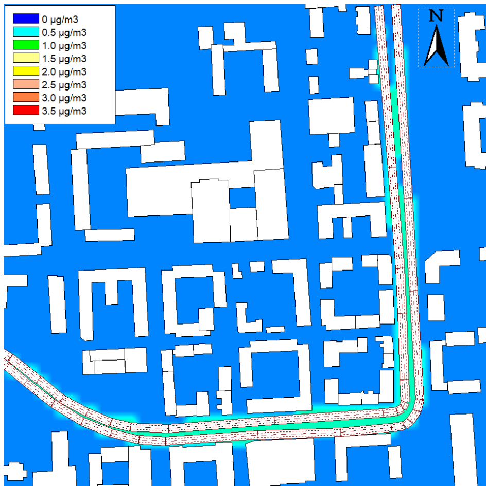
Figur 22. Framtida scenario 2040 , beräknade halter av kvävedioxid som dygnsmedelvärden (98-percentil) från Fortifikationsverkets följdverksamhet. Rådhusgatan går i nordsydlig riktning och Färjemansgatan i östvästlig riktning.
