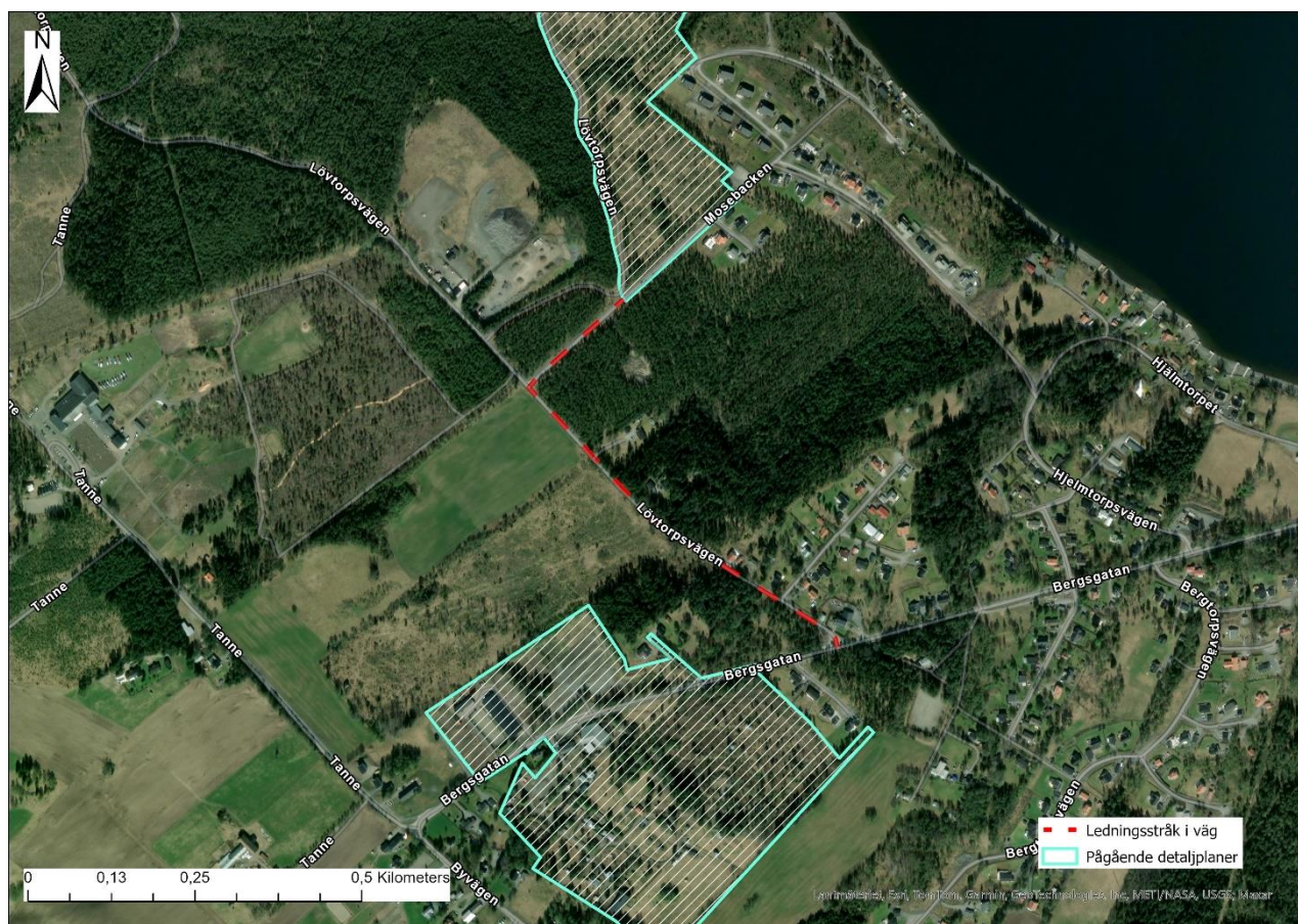
Figur 3. Ett möjligt ledningsstråk till pågående detaljplan i norr. Ledningen föreslås läggas i existerande väg. 610 meter totalt.
