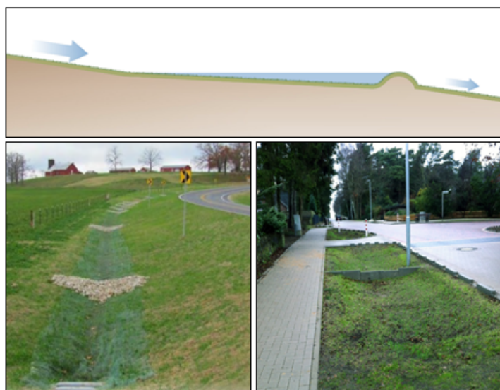
Figur 22. Diken med dämmen.
