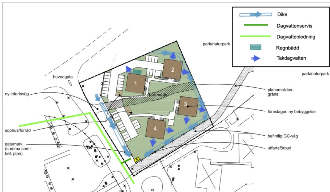
Figur 17. Föreslagen riktning på takavvattning till grönyta vidare till diken.
