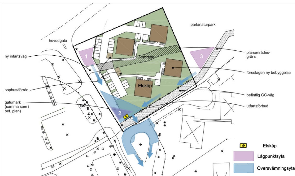
Figur 8. Översvämningssytor med flödesriktning vid skyfall.
