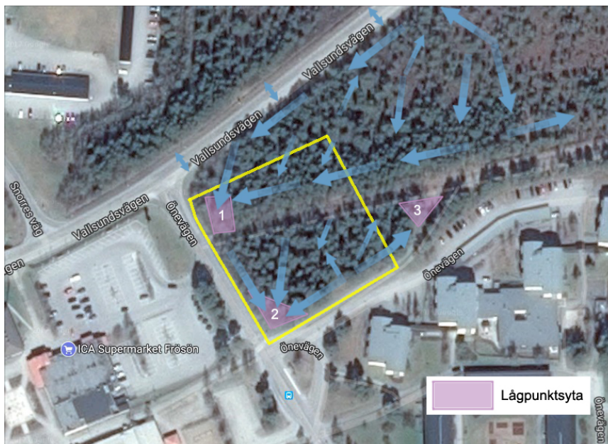
Figur 4. Befintlig avvattning av området med lågpunktsytor.
