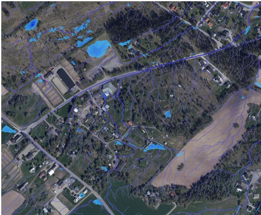
Figur 9. Avrinningsanalys i Scalgo med rinnvägar och dämningssområden.
