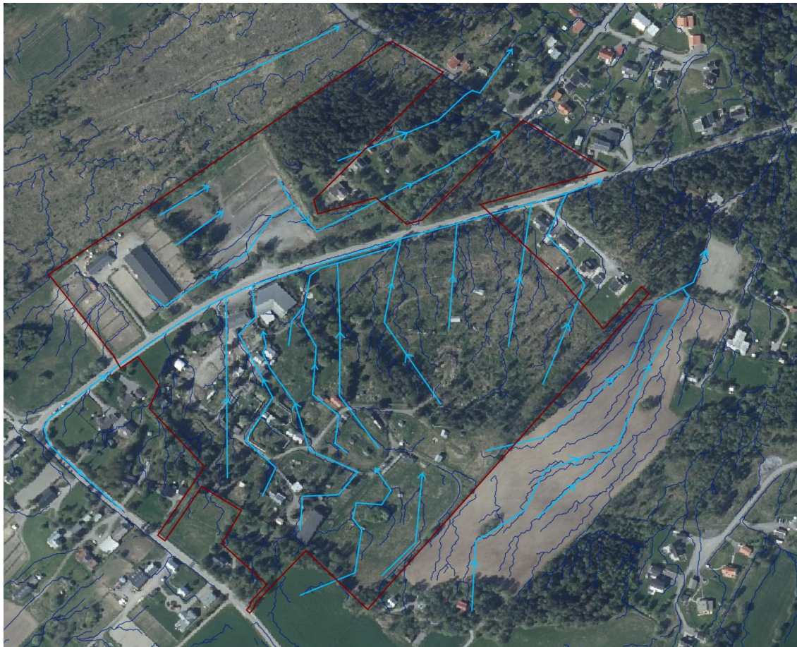
Figur 10. Scalgoanalys med rinnvägar och planområdesgräns. Avrinningsmönstret har förtydligats med ljusblå linjer med avrinningsriktningar.
