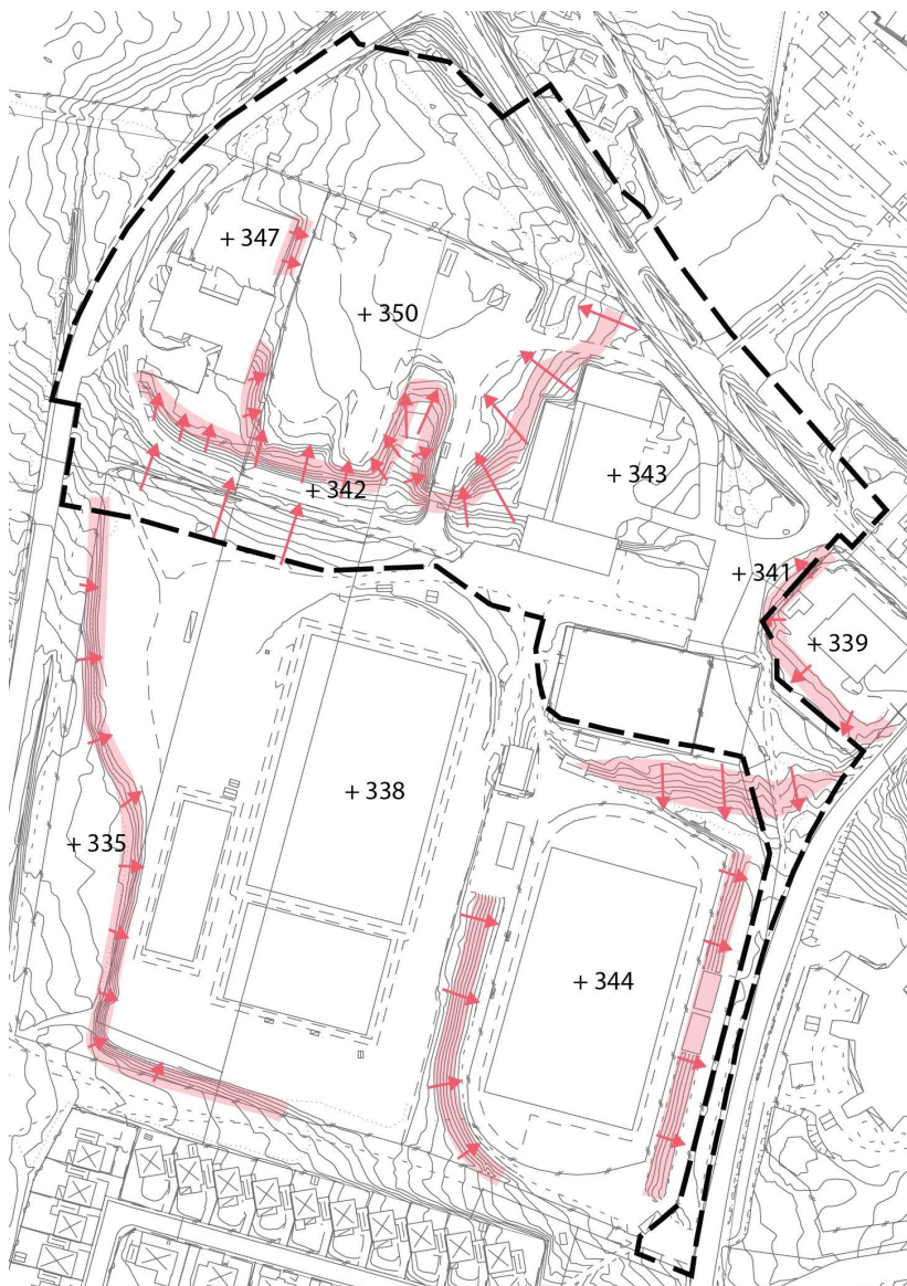
Figur 18: Karta som visar terrängförhållandena inom planområdet. Rosa markeringar visar brantare slänter där pilen pekar mot den högre nivån. Plushöjderna visar befintlig marknivå.
