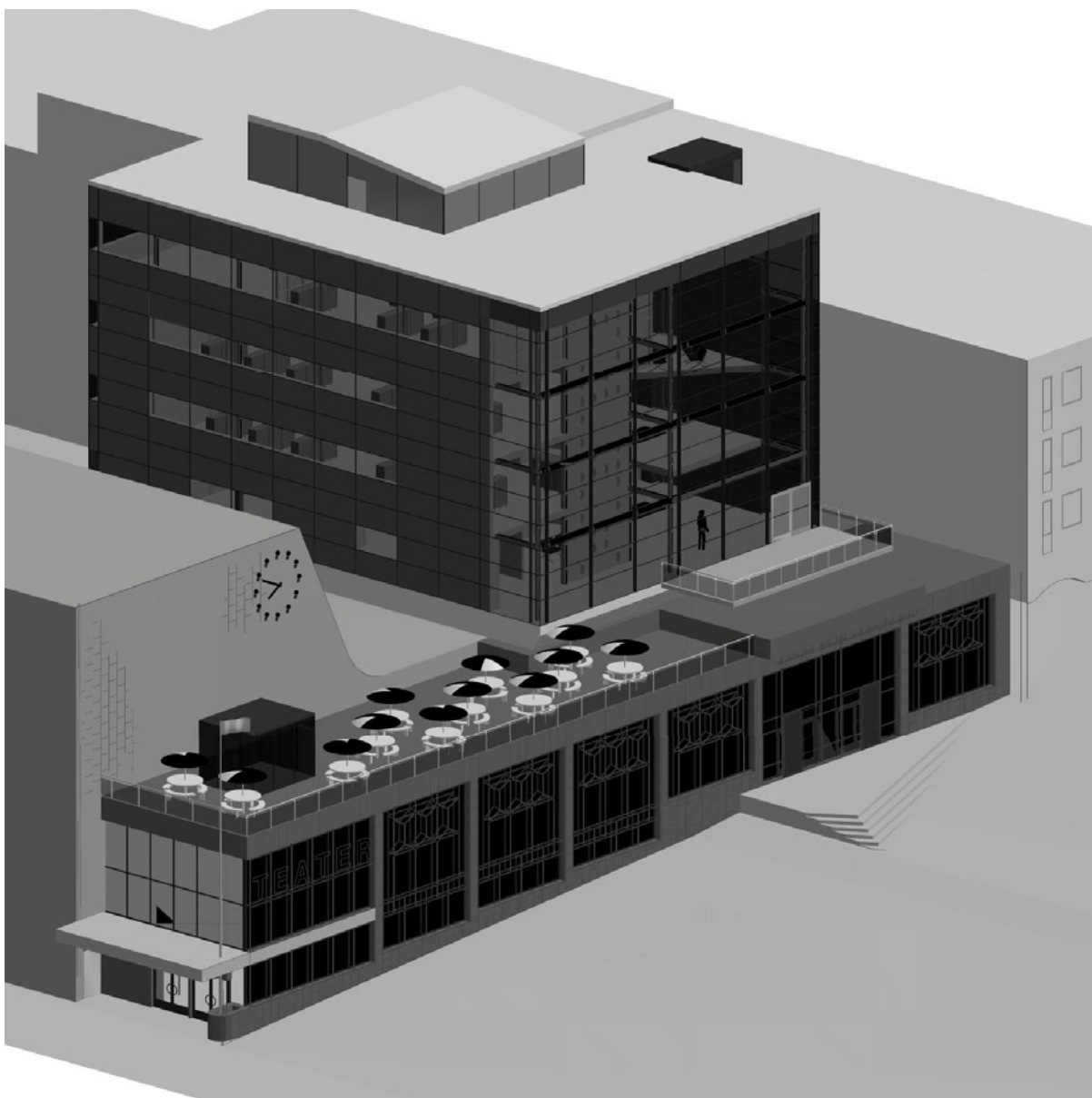
Illustration av terrasser dels framför kontorspåbyggnaden, dels ovanpå Storsjöteaterns foajé samt glasad byggnad för hiss/trappa i anslutning till teaterterrassen. Principvy ur CAD-model © SWECO FFNS juni 2007.
