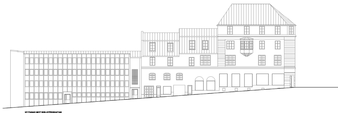
Bild 5. Sektion som visar dels befintlig fasad mot Biblioteksgatan samt förslag på ny fasad. Illustration: GisteråSjöstrand
