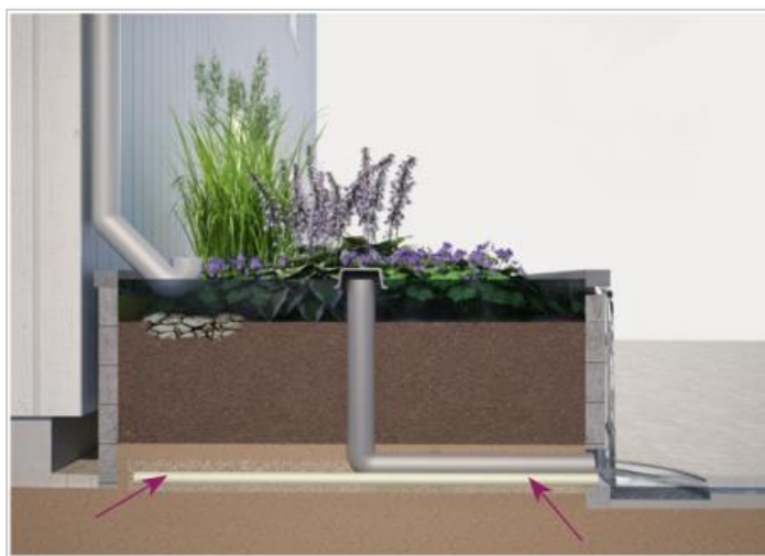
Figur 11: Upphöjd regnbädd med översvämningsskydd, bräddavlopp och dränering. Movium Faktblad, 2015.
