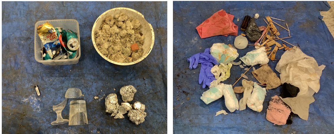
Bild 4.12 Metallförpackningar, inert material, övrig metall, övrigt glas och elavfall (t.v.), övrigt brännbart (t.h.) i matavfallet från flerfamiljshushåll.
