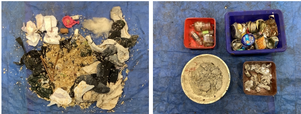
Bild 4.6 Övrigt brännbart (t.v.), glas- och metallförpackningar, inert material och övrigt metall (t.h.) i matavfallet från villahushåll.
