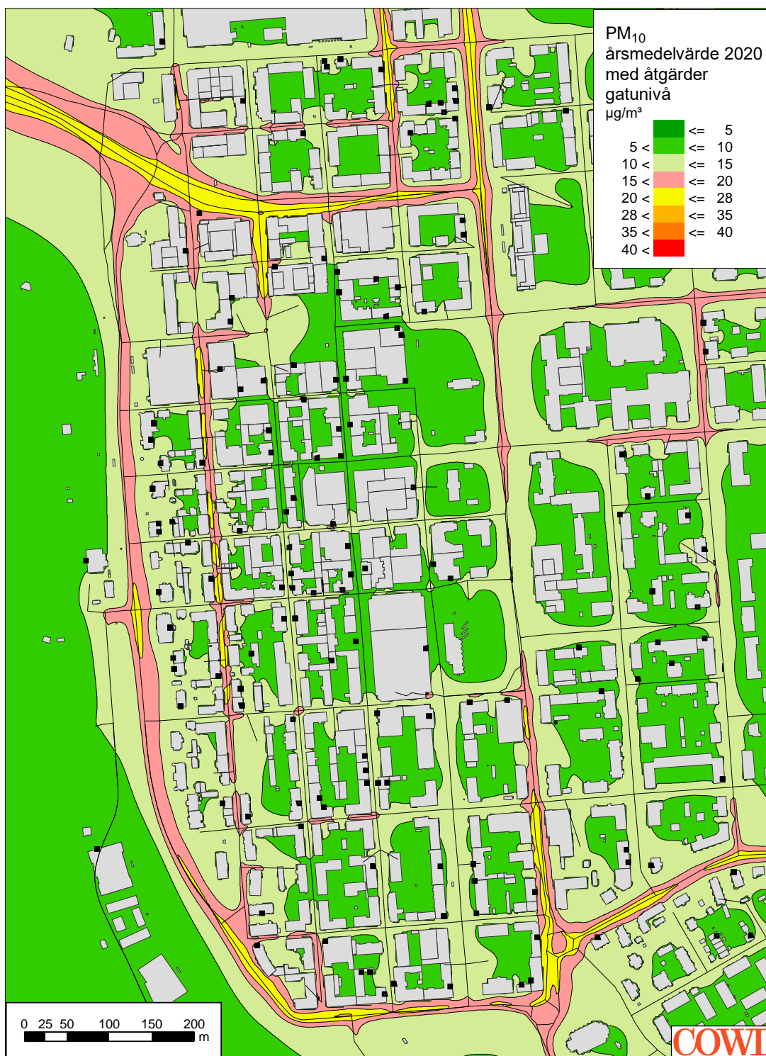
Figur 24 Årsmedelvärde av partiklar, PM 10 , med damningsdämpande åtgärder. Spridningsberäkning för år 2020 med Miskam för beräkningsområdet i centrala Östersund.
