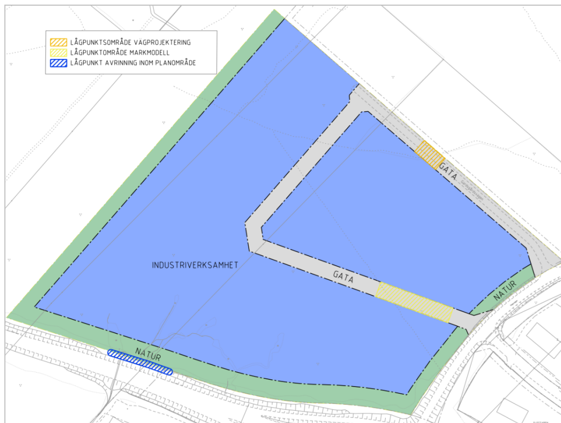
Figur 11. Instängda områden längs med planerad gata. Orange skrafferad yta redovisar lågpunkt enligt utförd FFU för vägprojektering. Gul skrafferad yta illustrerar bedömd lågpunkt för en vägprojektering utifrån markmodell och blå skrafferad yta lågpunkt för planområdet.
