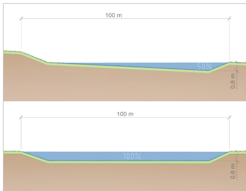
Figur 14. Schematisk bild av fördröjningsvolym för föreslaget dike med längsgående lutning på 5-10 ‰ jämfört med ett plant dike som kan omhänderta 100% av den öppna volymen i diket.
