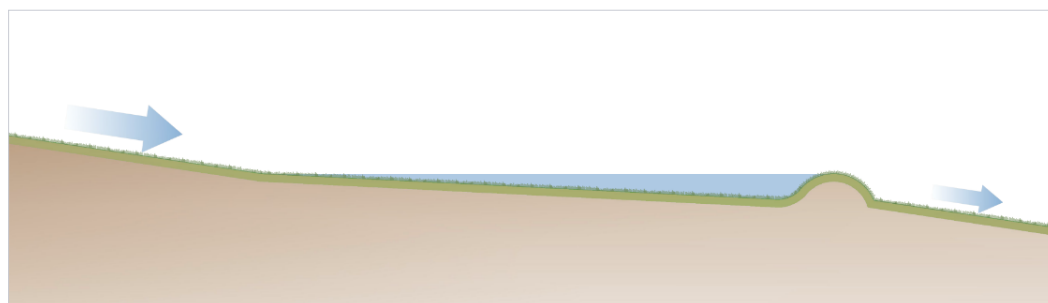
Figur 12. Schematisk bild på fördröjning i dike med hjälp av dämning.
