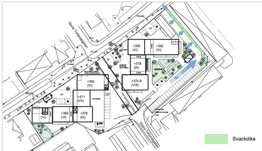
Figur 20. Förslag till dagvattenhantering med svackdike.
