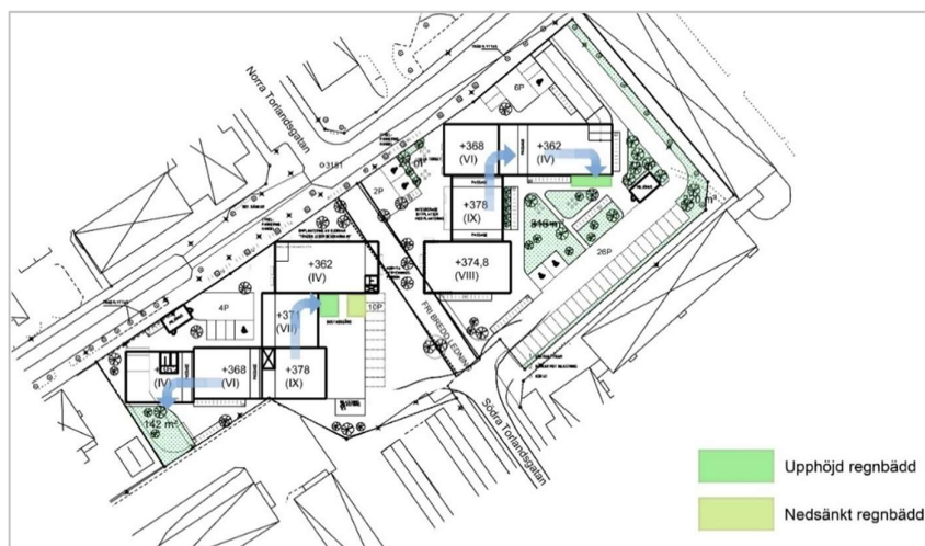
Figur 19. Ett förslag till dagvattenhantering, där takvatten leds till regnbädd och grönyta.
