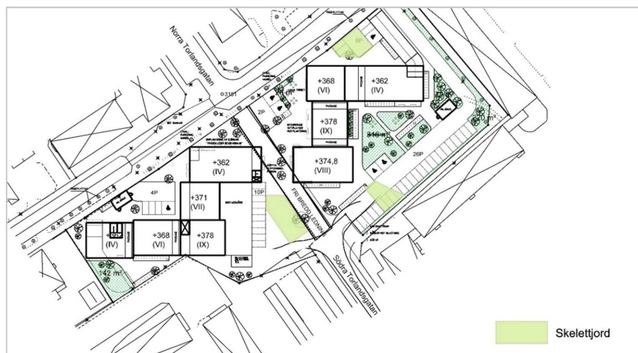
Figur 21. Förslag till dagvattenhantering med skelettjordar, där föreslagen totalyta är ca 350 m 2 .
