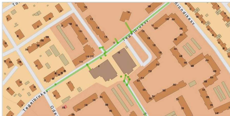
Figur 8. Schematisk bild av befintligt dagvattensystem.
