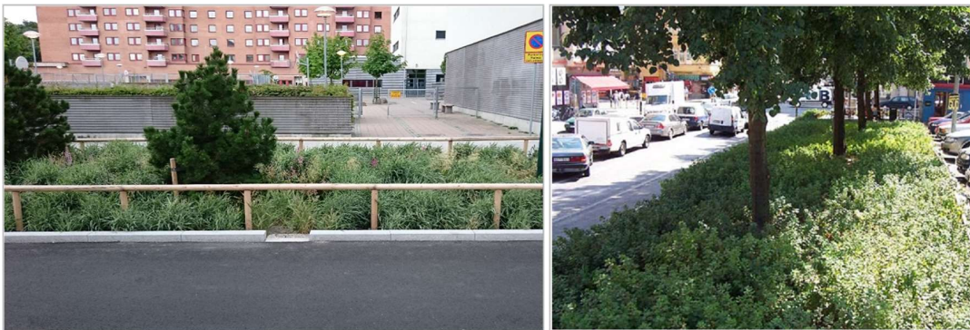
Figur 15. Till vänster, nedsänkt regnbädd med inlopp genom nedsänkt kantsten. (sigmacivil.se). Till höger, regnbädd med trädplantering i anslutning till parkering, foto: Björn Embrén.
